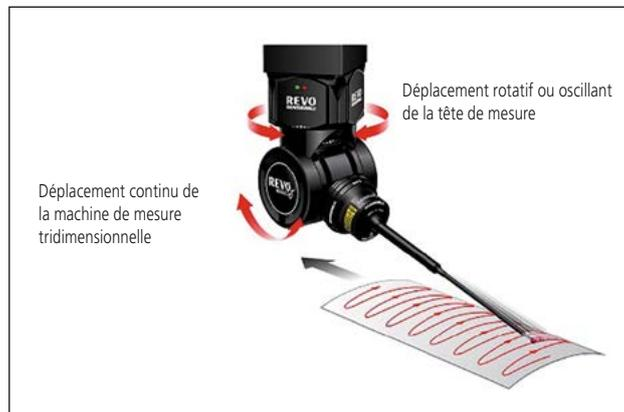
Avec le système de palpée Revo®, la fonction de scanning SweepScan permet des évaluations particulièrement efficaces des surfaces. Grâce à la fonction d'apprentissage de la boîte de dialogue, il est même possible d'utiliser cette fonction sans disposer du modèle CAO de la pièce.
