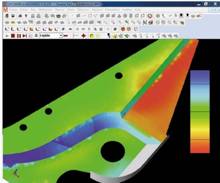
Grâce au système de représentation topographique, les écarts de la surface mesurée apparaissent sous forme de nuances de couleurs en comparaison à la surface du modèle CAO.
