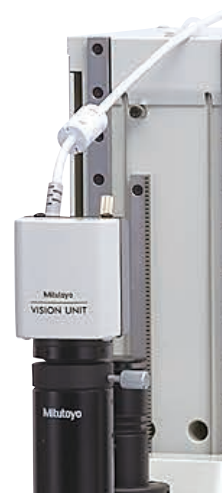
Vision Unit Wizyjny system pomiarowy współpracujący z komputerem PC
