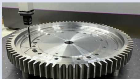
Skanowanie sondą SP80 z końcówką 100 mm.
