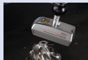
Laser typu flying spot jest zdolny do precyzyjnego skanowania trudnych części, jak tego wirnika i osiąga najwyższą dokładność skanowania w klasie.
