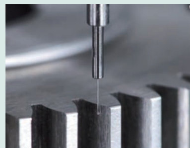
pomiar koła zębatego o module 0.8 z MPP-NANO
