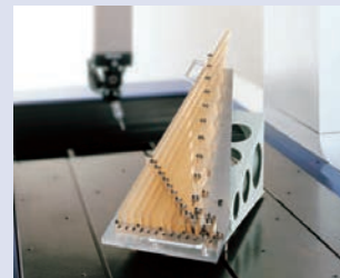
Kalibracja WMP przy użyciu wzorca szklanego o praktycznie zerowym współczynniku rozszerzalności temperaturowej
