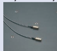
System kompensacji temperatury (czujniki temperatury)
