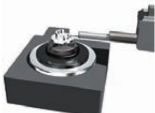
Pomiar przy użyciu stołu obrotowego osi 01
