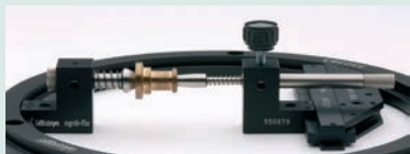
Mocowanie przedmiotu obrotowego w zaciskach kłowych.
