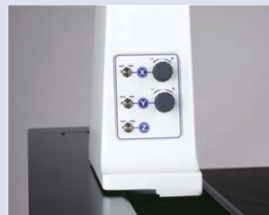
Przełączniki blokowania osi oraz pokrętał posuwu dokładnego do precyzyjnego pozycjonowania.
