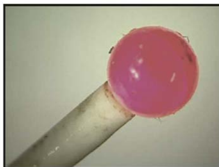
Zanieczyszczona końcówka trzpienia
