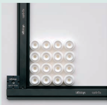
Pomiar seryjny części tego samego typu ustawionych względem listw montażowych.
