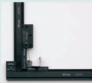
Listwa zębata umożliwia przechodzenie światła. Docisk sprężyny blokuje pozycję mierzonego przedmiotu.
