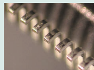
Przykład pomiaru : Wysokość wyprowadzeń obudowy QFP
