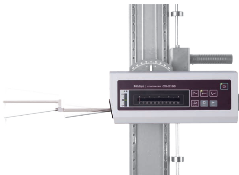
CV-2100 Funkcja opuszczania i unoszenia ramienia
